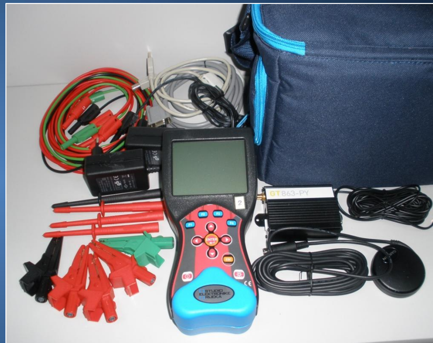
STER PMU uređaj u kompletu s GPS/GPRS modulom, kabelima, napajanjem i torbom
